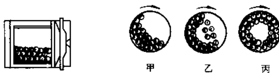
图 4-4 球磨机在不同转速下，圆球转动情况
