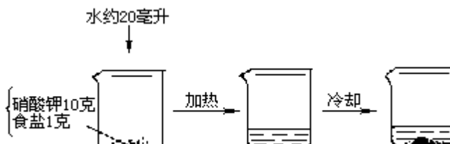
图2-8 用结晶法分离可溶性杂质
